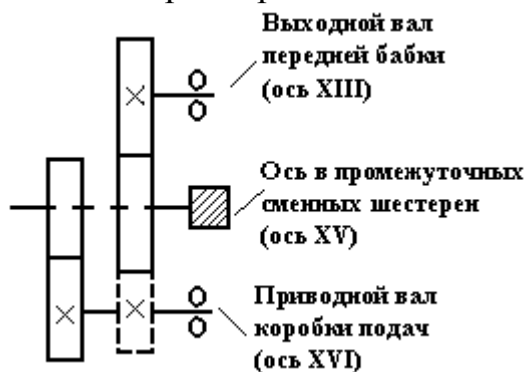
Рисунок 16 - Схема установки сменных шестерен
