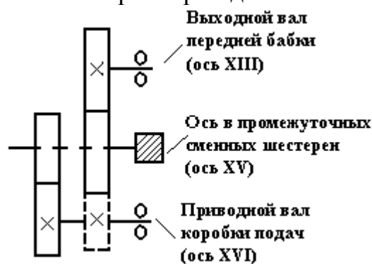
Рисунок 14 - Схема установки сменных шестерен
