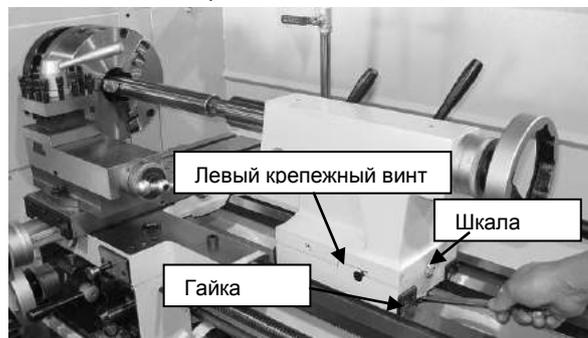
Рис. 32. Регулировка смещения задней бабки.
