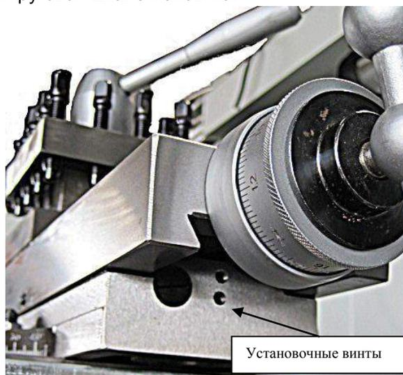
Рис. 80. Установочные винты для регулировки люфта суппорта.
