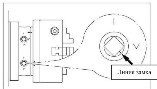
Рис. 7. Эксцентрик и линии.
