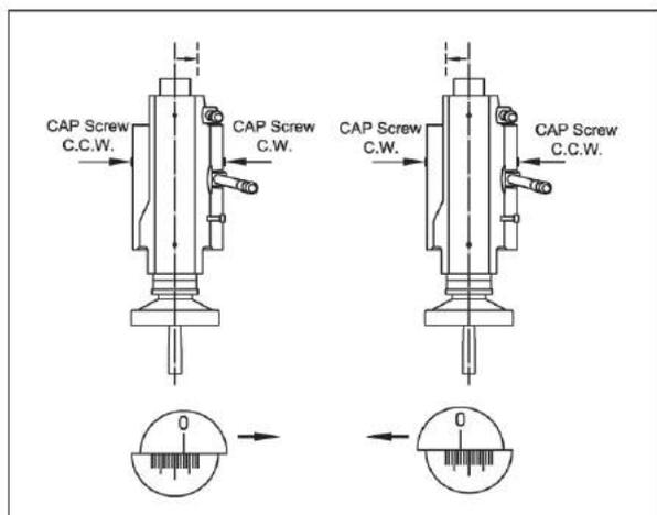
Рис. 33. Регулировка крепежных винтов для смещения задней бабки
