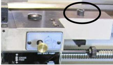
Рис. 19. Фиксатор салазок.
