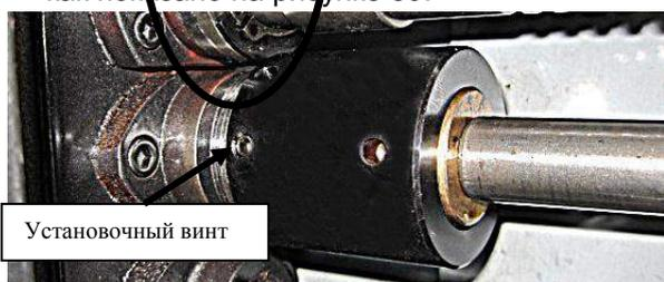
Рис. 89. Удаление установочного винта из ободка муфты.
