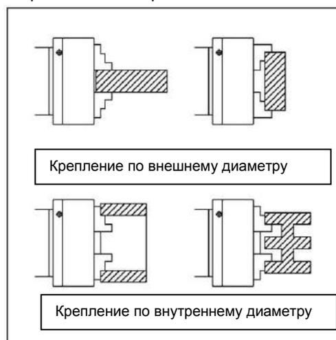
Рисунок 30. Примеры крепления заготовки в 3-х кулачковом патроне.
