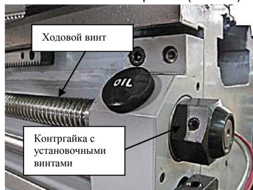
Рис. 82. Регулировка люфта ходового винта
