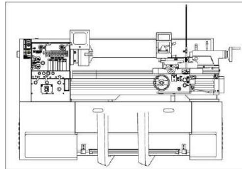
Рис. 11. Перемещение станка с помощью вилочного погрузчика.
