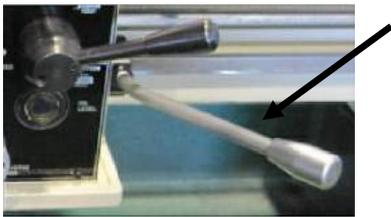
Рис. 20. Рукоятка Вкл./Выкл. шпинделя.
