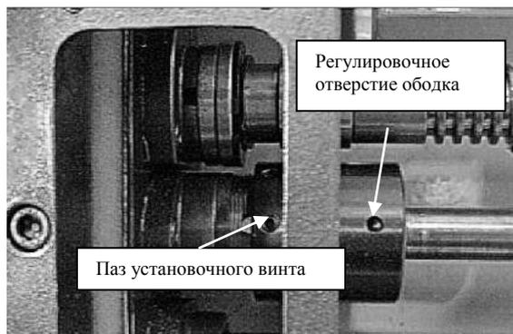
Рис. 90. Выравнивание установочного винта муфты подачи.
