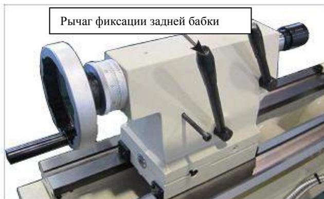
Рис. 8. Рычаг фиксации задней бабки.
