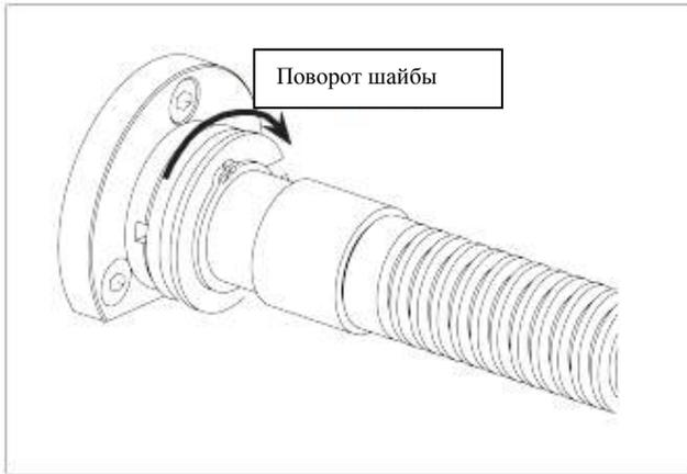
Рис. 101. Позиционирование шайбы.
