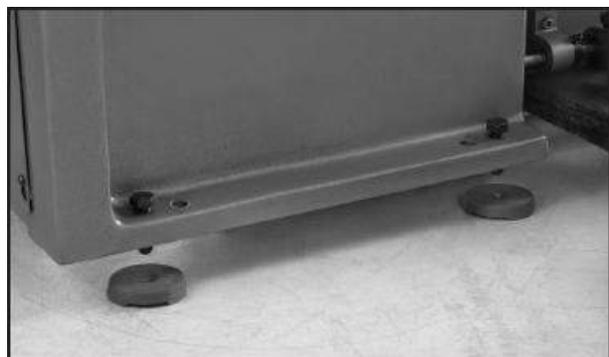
Рис.12. Выравнивание ножек и винтов
