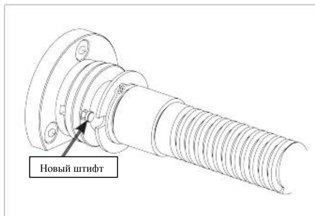
Рис. 100. Новый срезной штифт, установленный в отверстии.
