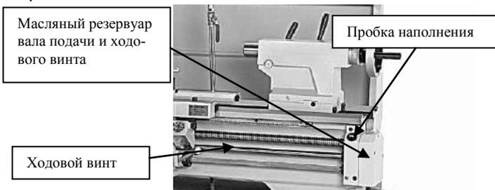
Рис. 72. Смазка ходового винта
