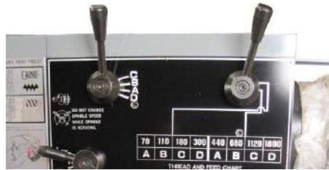
Рис. 15. Рукоятка переключения диапазонов передней бабки.
