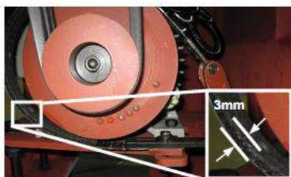
Рис. 93. Минимальная толщина ременной прокладки тормоза
