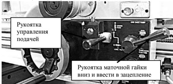
Рис. 51. Установка элементов управления кареткой для нарезания резьбы
