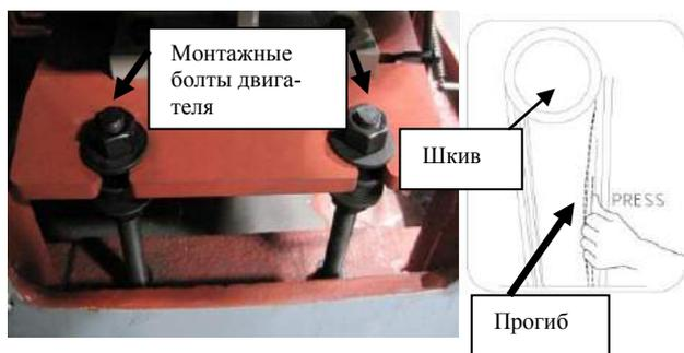
Рис. 92. Регулировка зубчатого ремня.
