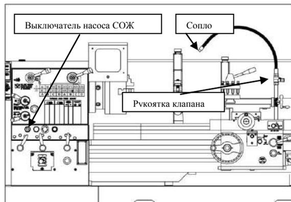
Рис. 66. Элементы управления системой охлаждения и узлы.
