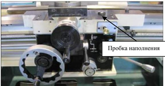
Рис. 71. Расположение пробки наполнения масляного резервуара салазок суппорта.
