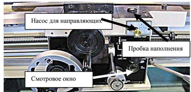
Рис. 73. Расположение насоса направляющих, пробки наполнения и смотрового окна салазок.
