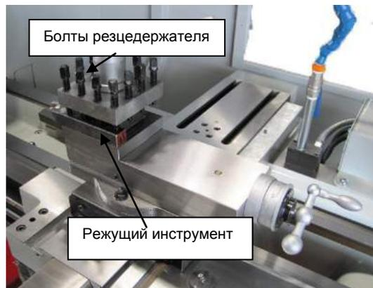
Рис. 39. 4-х позиционный резцедержатель.
