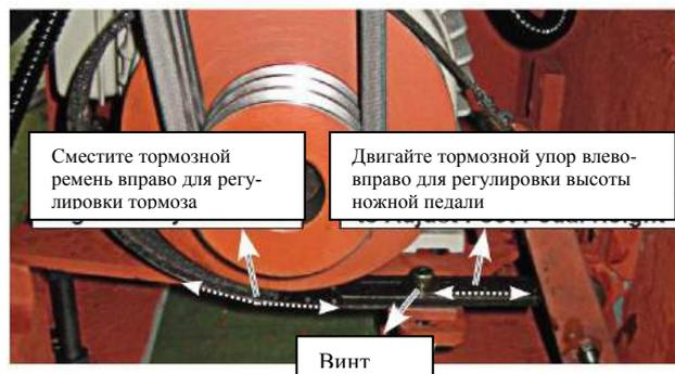
Рис. 94. Регулировка тормозной передачи.
