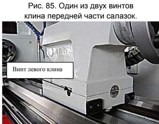
Рис. 85. Один из двух винтов клина передней части салазок.
