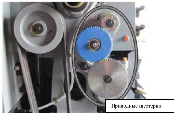
Рис. 77. Расположение приводных шестерен, которым требуется смазка.
