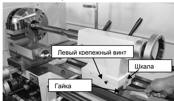
Рис. 32. Регулировка смещения задней бабки.
