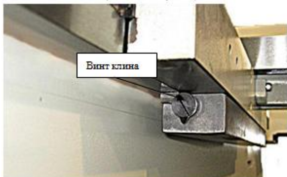
Рис. 84. Один из двух винтов заднего клина салазок.
