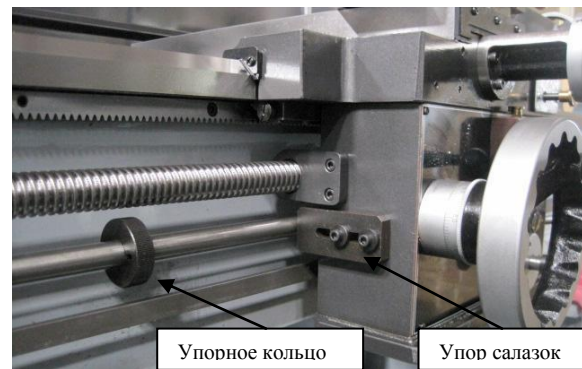
Рис. 41. Упор салазок и упорное кольцо.
