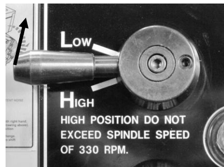
Рис. 22. Рукоятка переключения диапазонов коробки скоростей
