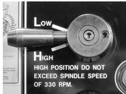
Рис. 16. Рукоятка диапазона коробки скоростей.
