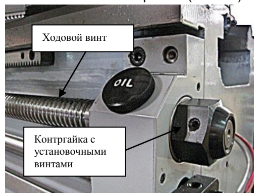
Рис. 82. Регулировка люфта ходового винта
