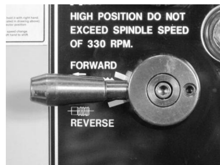
Рис. 17 Рукоятка выбора направления подачи Вперед (Forward)/Назад (Reverse)
