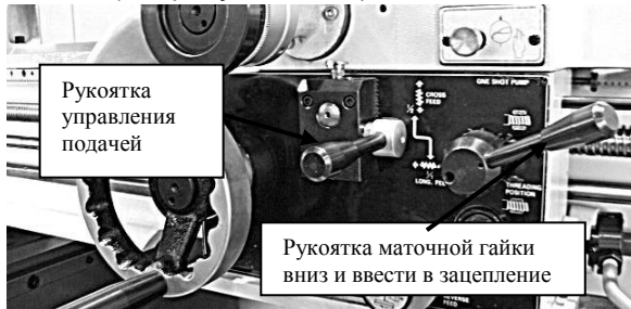
Рис. 51. Установка элементов управления кареткой для нарезания резьбы
