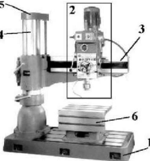
**1 Основание:** опора станка. В основании станка находится СОЖ, на основании установлен стол коробчатого сечения.
