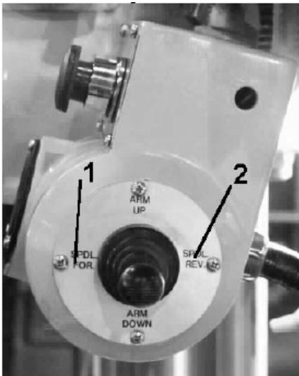
1. Включите главный выключатель, опустите пиноль на 5 мм так, чтобы можно было запустить функцию главного шпинделя «forward/reverse» – по часовой стрелке/против часовой стрелки.
