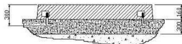
Эти схемы предназначены для основания и анкерных болтов, и для соответствующего положения станка JRD-920R.
