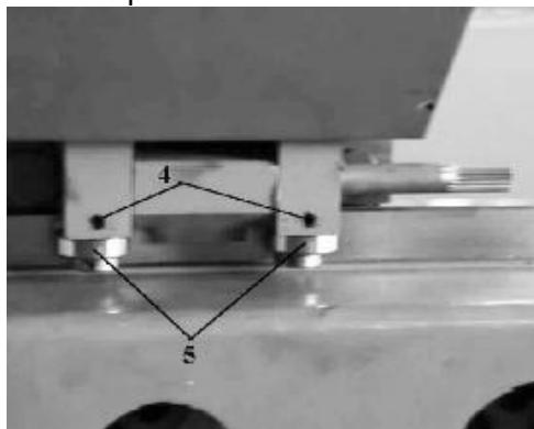
в. Ослабьте болты (см. Рис., № 4). Вставьте торцевой ключ в отверстия (см. Рис., № 3) и поворачивайте его таким образом, чтобы маховик редуктора вращался свободно, но не болтался. Ту же операцию проделайте с противоположной стороны.
